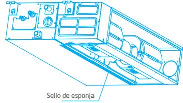
3. Cuando instale el filtro de malla, por favor, conéctelo a la pestaña inclinada de abertura de retorno de aire y, a continuación, empuje hacia arriba.
